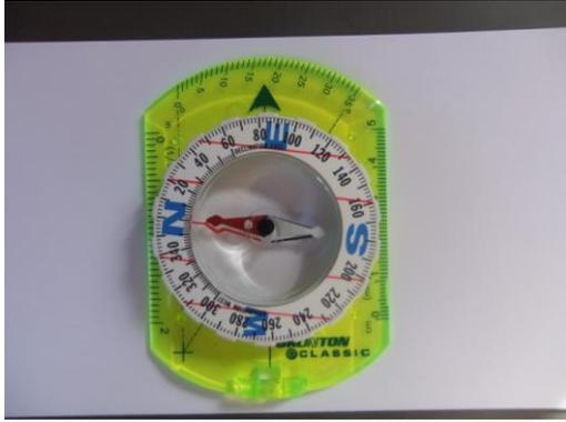
Dans cet exemple, le Nord est à ma gauche, l'aiguille rouge est positionnée sur le repère du cadran, la flèche du support est devant moi, dans la direction à prendre.
