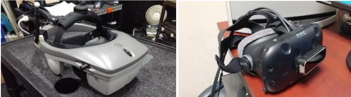
**Figure 2.** Visiocasques. Visiocasque *nVisor Sx* (à gauche) et *HTC Vive* avec capteur de localisation des mains (à droite) utilisé suite au bris d'équipement.
