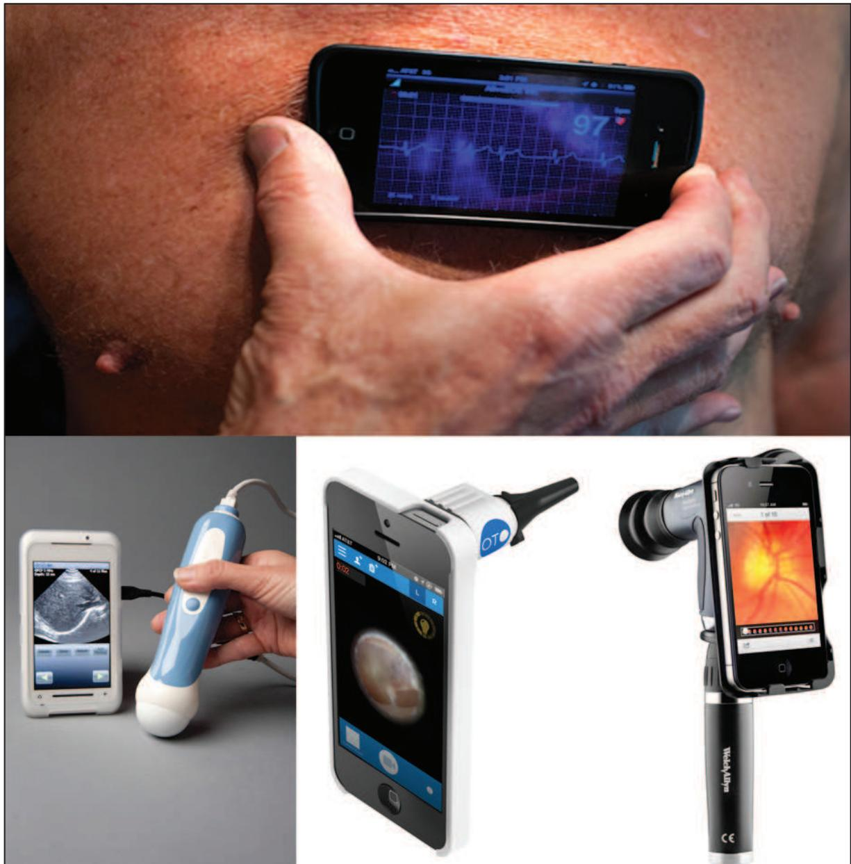
**Figure 29 : exemples d'utilisations médicales de Smartphones à l'aide d'accessoires : l'électrocardiographe sans fil, la mini sonde échographique, l'otoscope et l'ophtalmoscope.**
